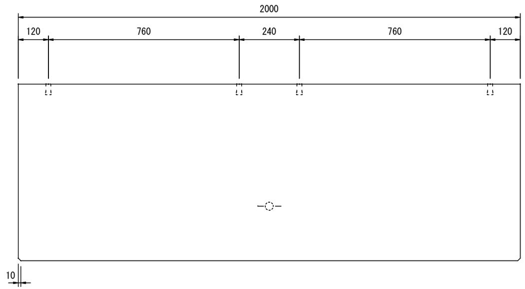
マルチスリット削溝 800×600×2000 製品重量 1063 kg
