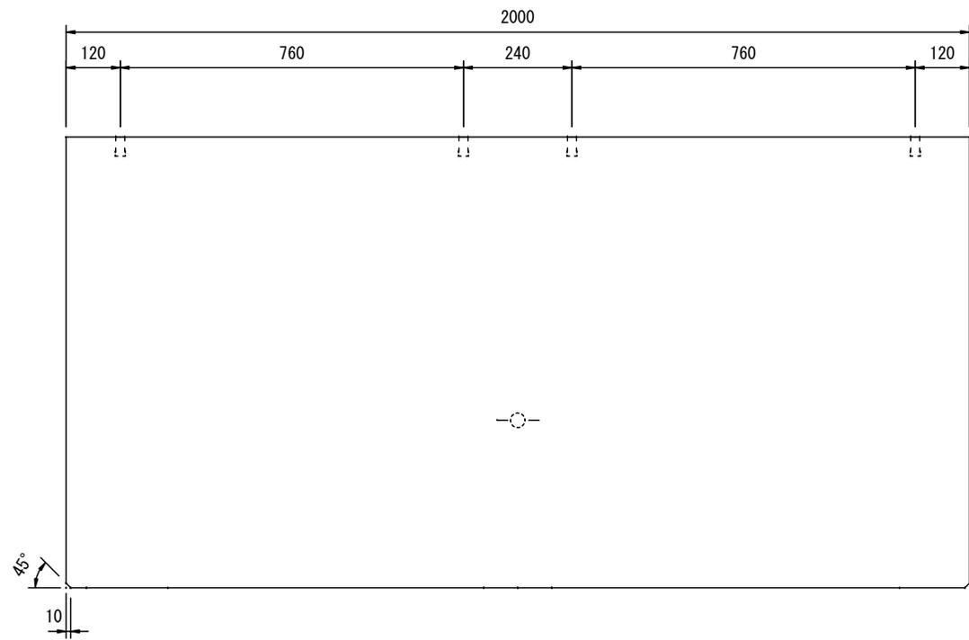
マルチスリット側溝 500\*900\*2000 製品重量 947 kg
